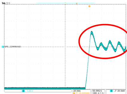
출력 오프셋: 1000 rpm 출력 스케일: 100rpm/V
